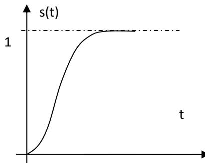
Q2 : l'écart statique en position vaut 0 puisque entrée et sortie valent 1 en régime permanent. Ce qui peut s'écrire :  $\varepsilon_s = \lim_{t \rightarrow \infty} (e(t) - s(t)) = 1 - 1 = 0$ . Le système est précis. La valeur de la sortie rejoint celle de l'entrée en régime permanent. le système est correctement asservi.
