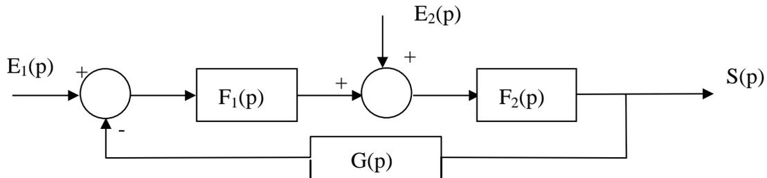
Exprimer  $H_1(p)$  et  $H_2(p)$  en fonction des transmittances  $F_1(p)$  et  $F_2(p)$  et  $G(p)$ .
