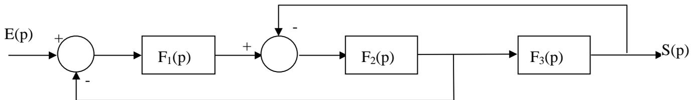
Déterminer la fonction de transfert  $H(p)$  telle que  $S(p) = H(p).E(p)$  en fonction de  $F_1(p)$ ,  $F_2(p)$ ,  $F_3(p)$ .
