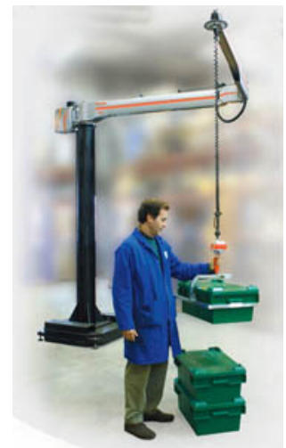
FIGURE 4 – Bras manipulateur en situation
