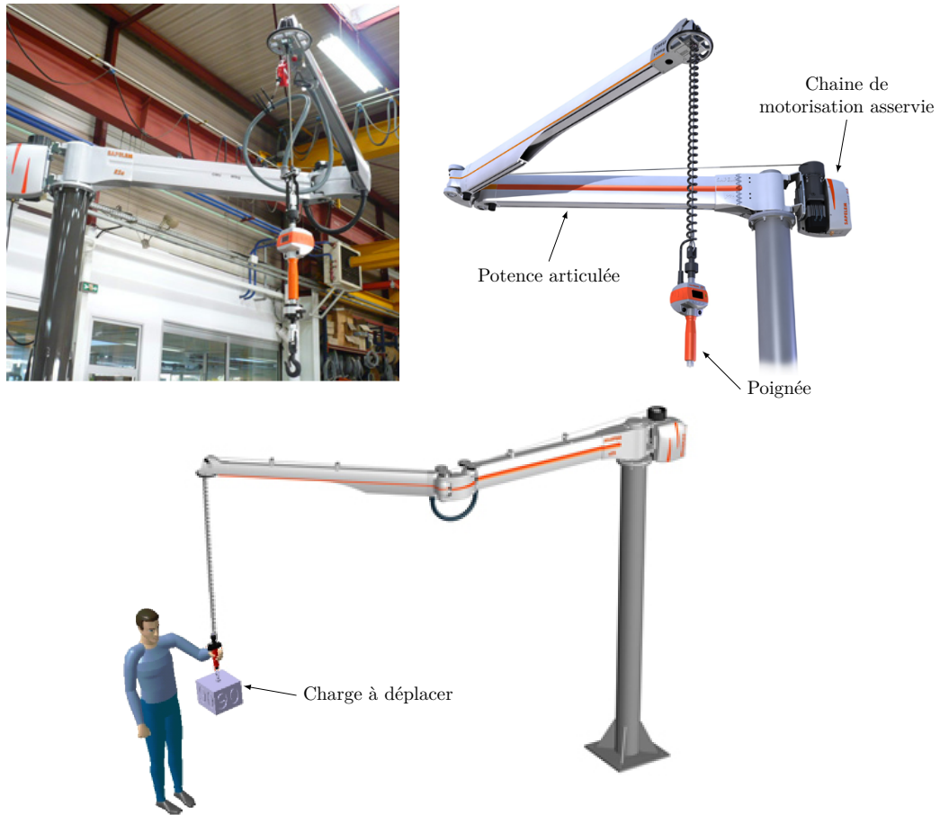
FIGURE 1 – Photos du bras manipulateur collaboratif SAPELEM et d'un environnement de manutention
