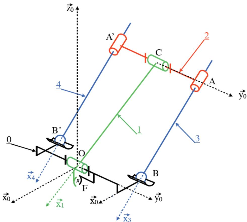
Q2. Les mouvements utiles du système se produisent tous dans le plan  $(\vec{x}_0, \vec{z}_0)$ , c'est-à-dire des translations dans ce même plan ou des rotations autour de l'axe  $\vec{y}_0$ .
