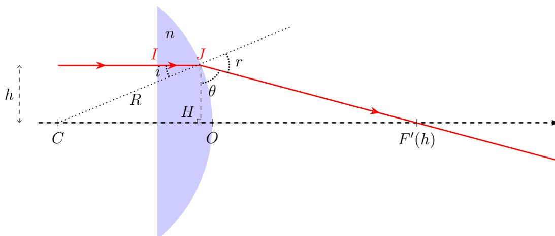
Un rayon incident arrive parallèle à l'axe à une distance  $h$  de l'axe, et entre dans la lentille. Après deux réfractions en  $I$  puis en  $J$ , il ressort et coupe l'axe en un point noté  $F'(h)$ . Le but de ce TD est de trouver la position de  $F'(h)$ , plus précisément de déterminer  $f'(h) = \overline{OF'(h)}$ , afin de voir si elle dépend de  $h$  ou pas (condition de stigmatisme).
