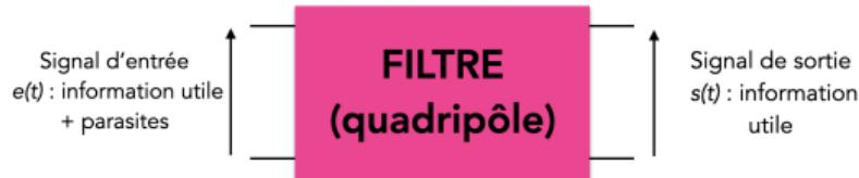
Le gain en décibel est  $G_{dB} = 20 \log|\underline{H}|$ ,  $|\underline{H}|$  étant le rapport des amplitudes sortie/entrée.
