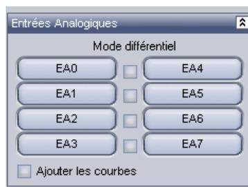
Avec ses 8 entrées analogiques numérotées de 0 à 7 (EA0 à EA7), le boîtier permet d'acquérir simultanément 8 **tensions mesurées entre l'entrée correspondante et la masse du boîtier**.
