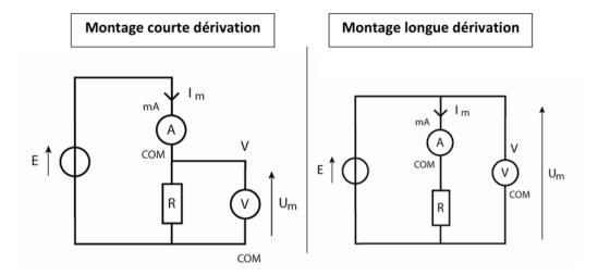
Un appareil de mesure ne doit pas modifier le fonctionnement du circuit électrique.
