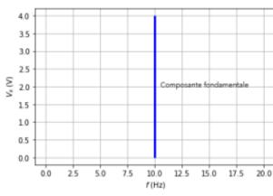
Spectre d'un signal sinusoïdal
