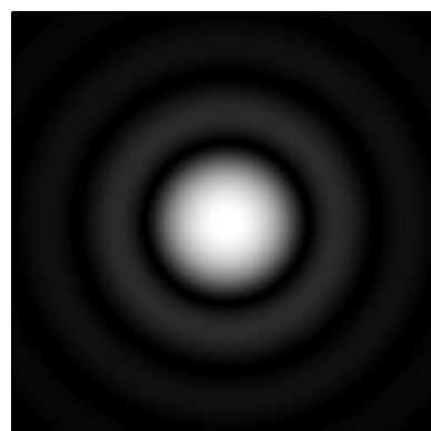
Tâche de diffraction d'une ouverture circulaire
