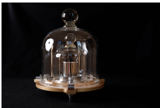
FIGURE 1 – À gauche : l'un des étalons en platine iridié, protégé sous deux cloches en verre, qui servait jusqu'en 2019 à définir le kilogramme. À droite : évolutions de l'écart de masse des six témoins officiels à la masse du prototype international du kilogramme (Thomas M. et al. ). L'ajustement linéaire représenté en rouge donne une pente de l'ordre de 0,25 μg par an.
