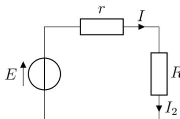
La résistance équivalente du circuit est cette fois  $r + R$ , d'où  $I = I_2 = E/(r + R)$ . Si une ampoule est grillée, le courant  $I_2$  traversant l'autre ampoule est
