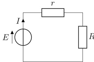
La résistance équivalente vaut  $R + r$ , donc l'intensité  $I$  du courant dans le circuit vaut  $E/(R + r)$ . La puissance reçue par la résistance  $R$  s'écrit donc
