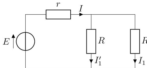
La résistance équivalente du circuit est  $r + R/2$ , d'où  $I = 2E/(2r + R)$  et on reconnaît un pont diviseur de courant, d'où immédiatement  $I_1 = I_1' = I/2$ . Si les deux ampoules sont allumées, le courant  $I_1$  traversant une ampoule est donc
