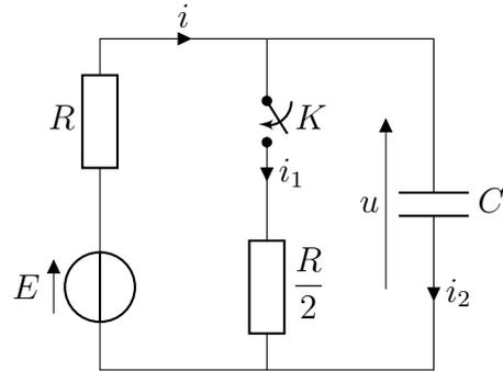
1. On suppose qu'avant la fermeture de l'interrupteur, le régime permanent est établi. Faire un schéma équivalent du circuit à  $t = 0^-$  et exprimer  $i$ ,  $i_1$ ,  $i_2$  et  $u$  à l'instant  $t = 0^-$ , juste avant la fermeture de l'interrupteur.
