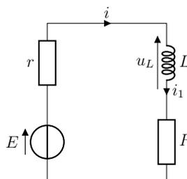
La loi des mailles s'écrit  $E = (R + r)i_1 + u_L$ . En utilisant la loi de comportement de la bobine, puis en divisant par  $L$ , on obtient
