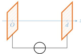
1. Orienter le champ électrique  $\vec{E}$  dans le dispositif et en déduire l'orientation du générateur en représentant la tension  $U$  à ses bornes. Exprimer le champ  $\vec{E}$  en fonction de  $U$ ,  $d$  et  $\vec{e}_z$ .
