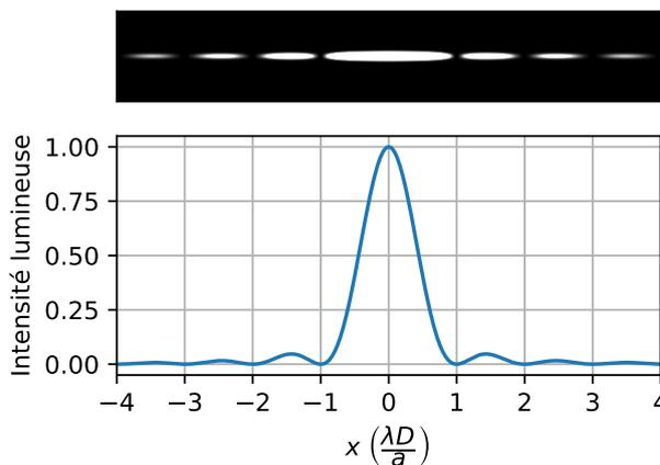
On souhaite vérifier l'information du fabricant donnant la largeur  $a$  d'une fente à partir de l'étude de la figure de diffraction obtenue. On note  $\Delta D$ ,  $\Delta d$  et  $\Delta \lambda$  les incertitudes associées aux mesures de  $D$ ,  $d$  et à la donnée de  $\lambda$ .
