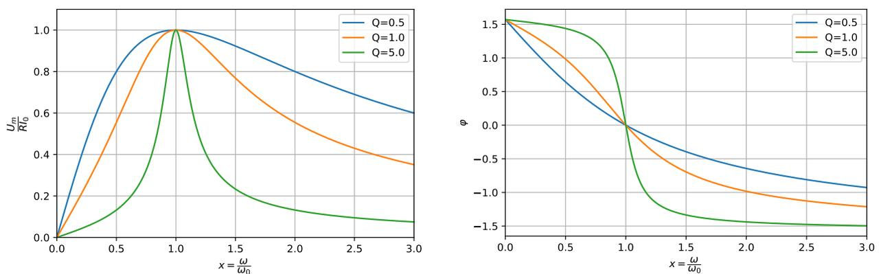
FIGURE 1 – Amplitude et phase de la tension  $u(t)$  au voisinage de la résonance.
