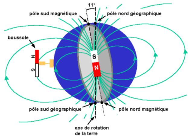
Une boussole est un instrument simple qui permet de le mettre en évidence. En effet, l'aiguille aimantée d'une boussole placée dans un champ magnétique s'aligne avec la composante du champ contenue dans le plan de la boussole.
