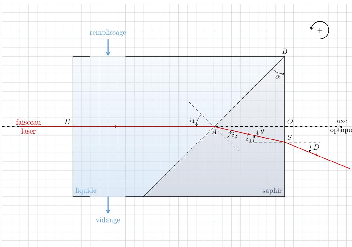
FIGURE 1 – Réfractomètre.
