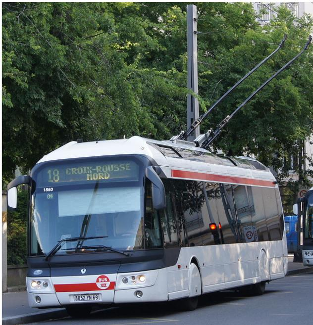
La ligne électrique d'un trolley (un bus électrique) est alimentée par une source de tension  $E = 750 \text{ V}$ . Le trolley est connecté à la ligne par deux perches de résistance  $r = 0,1 \Omega$  chacune.
