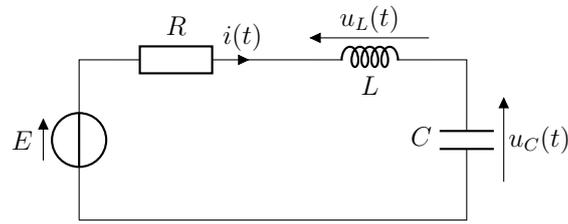
Dans le circuit RLC série représenté ci-dessus, la tension  $u_C(t)$  aux bornes du condensateur, sa charge électrique  $q(t)$  et l'intensité du courant  $i(t)$  vérifient l'équation d'un oscillateur amorti :
