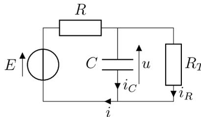
La loi des mailles dans la maille de gauche s'écrit  $E = Ri + u$ , d'où, en utilisant la loi des nœuds  $E = R(i_R + i_C) + u$ . En utilisant les lois de comportement, on obtient
