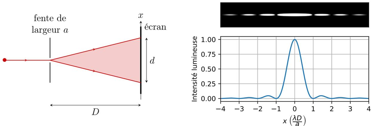
On souhaite vérifier l'information du fabricant donnant la largeur  $a$  d'une fente à partir de l'étude de la figure de diffraction obtenue. On note  $\Delta D$ ,  $\Delta d$  et  $\Delta \lambda$  les incertitudes associées aux mesures de  $D$ ,  $d$  et à la donnée de  $\lambda$ , c'est-à-dire les demi-largeurs des intervalles certains.
