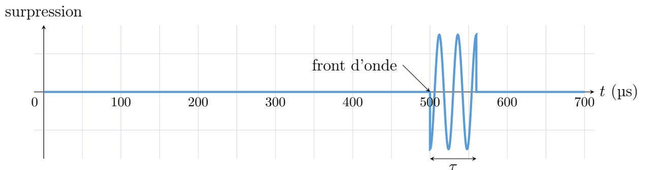
5. Sur l'écran de l'oscilloscope, on lit un décalage temporel entre les deux signaux  $\Delta t \approx 100$  ms. La durée  $\Delta t$  qui sépare l'émission d'une impulsion ultrasonore et la réception de son écho correspond au temps de vol de l'impulsion sur un aller-retour après réflexion sur le sol. Cela correspond à un retard dû à une propagation sur une distance  $2H$ , d'où
