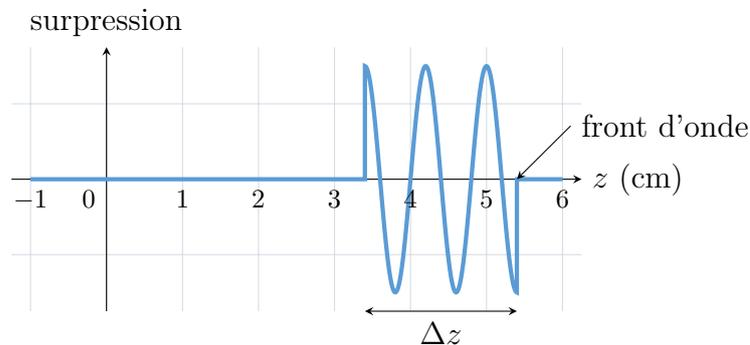
4. Le front d'onde arrive sur le capteur à l'instant  $(z - \Delta z)/c = 500$   $\mu$ s. La durée du signal est  $\tau = \Delta z/c \approx 60$   $\mu$ s.
