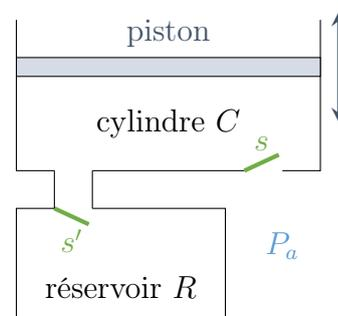
Le volume du réservoir  $R$ , canalisations comprises, est  $V$ . Le volume offert au gaz dans  $C$  varie entre un volume maximum  $V_M$  et un volume minimum  $V_m$ , volume nuisible résultant de la nécessité d'allouer un certain espace à la soupape  $s$ .
