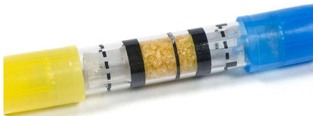
Les alcootests jetables sont constitués d'un sachet gonflable de capacité 1 L et d'un tube en verre contenant des cristaux orangés de dichromate de potassium  $\text{K}_2\text{Cr}_2\text{O}_7$  en milieu acide. Ceux-ci se colorent en vert au contact de l'alcool.
