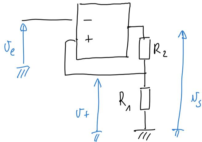
\* Diviseur de tension  $v^+ = \frac{R_1}{R_1 + R_2} v_s$
