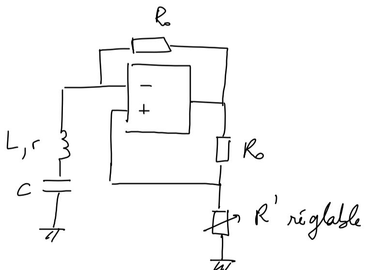
$$\left( \frac{d^2 u_c}{dt^2} + \omega_0^2 u_c = 0 \text{ avec } \omega_0^2 = \frac{1}{LC} \right)$$
