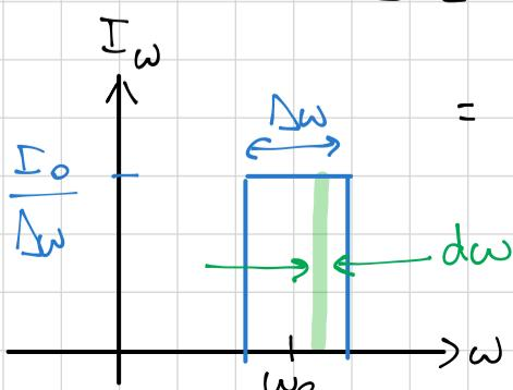
On considère que les rayons correspondant à des valeurs de  $\omega$  dans l'intervalle  $\left[\omega_0 - \frac{\Delta\omega}{2}, \omega_0 + \frac{\Delta\omega}{2}\right]$  ne sont pas cohérents : on somme les intensités pour obtenir l'intensité sur l'écran
