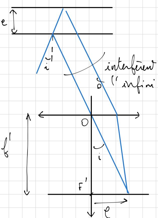
L'écran doit être placé dans le plan focal image d'une lentille convergente
