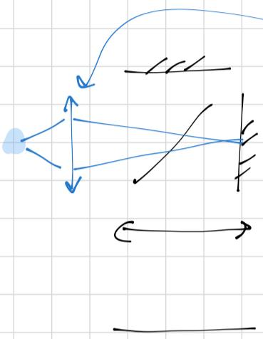
un condenseur (lentille de courte focale) permet de faire l'image de la source au niveau des miroirs).
