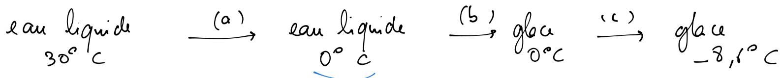
$$\Delta S_{(a)} = m_1 c_l \ln\left(\frac{T_0}{T_i}\right) \quad \text{avec } T_0 = 273K \text{ et } T_i = 303K$$
