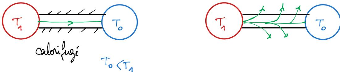
On peut associer une direction et un sens au transfert thermique : on introduit un vecteur appelé **vecteur densité de flux thermique**  $\vec{j}_{th}$  tel que :
