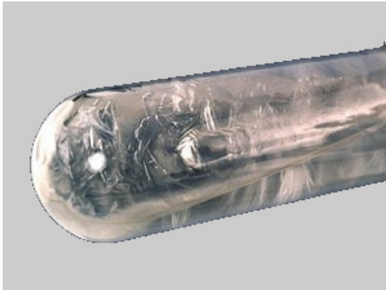
Figure 1 Appareil à point triple de l'eau
