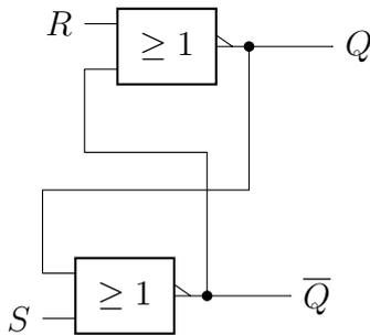
Les bascules sont les éléments de logique séquentielle dont la fonction essentielle est la mémorisation. La bascule RS est une bascule **bistable** pouvant commuter d'un état **stable** à un autre par commande extérieure :
