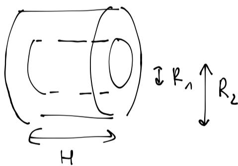
D : espace entre les deux cylindres de hauteur  $H$  de rayons  $R_1$  et  $R_2$ .
