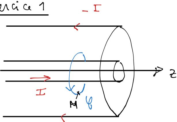
1) Symétrie: le plan  $(M, \vec{\mu}_r, \vec{\mu}_z)$  est un plan de symétrie de la distribution de courant donc  $\vec{B}(M) = B(M) \vec{\mu}_\phi$
