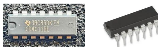
Figure 3 – Circuit intégré TI CD-4011
