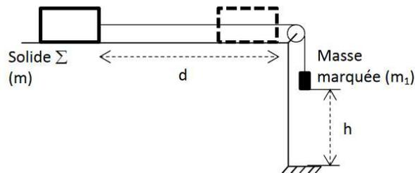
Le solide  $\Sigma$ , initialement immobile, est entraîné par la chute de la masse marquée sur une hauteur  $h$ . Après avoir franchi la longueur  $h$ , le solide  $\Sigma$  frottant sur le support horizontal parcourt encore une distance  $d - h$  avant de s'immobiliser à nouveau. En supposant que le fil est inextensible, que la liaison pivot au niveau de la poulie est parfaite et que les masses du fil et de la poulie sont négligeable, les coefficients de frottement s'expriment :
