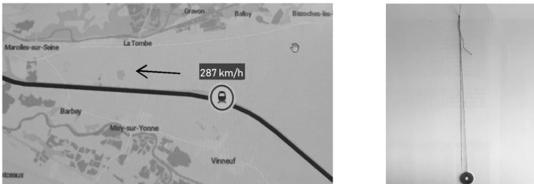
FIGURE 9 – La carte permet d'estimer que le rayon de courbure du virage lors de la réalisation de l'expérience est  $R_C = 4 \text{ km}$ . Sur la photo à droite, le segment noir matérialise la verticale lorsque le train est à l'horizontale.
