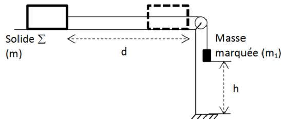
L'expérience de la traction par lest, schématisé ci-contre, est une méthode permettant de déterminer simultanément les coefficients de frottement statique  $\mu_s$  et dynamique  $\mu_d$  d'un couple de matériaux. La chute du système de masse réglable  $m_1$  sur une hauteur fixée  $h$  entraîne, via une poulie, un déplacement du solide de masse fixée  $m$  sur une distance  $d > h$  à mesurer. Les coefficients se déduisent des mesures de  $m_1$  et  $d$ .
