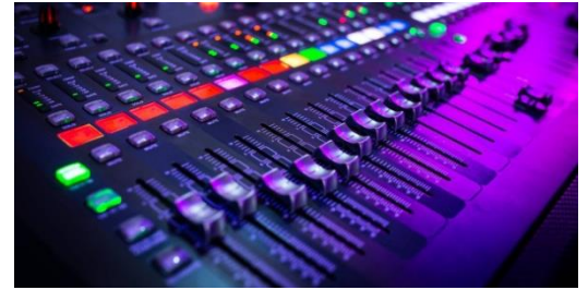
Les tables de mixage sont utilisées par les Disc-jockeys (DJ) pour réaliser des transitions douces et des effets sur une succession d'enregistrements musicaux. Certains effets requièrent l'action d'un filtre, qui est réalisé par coupure dans le domaine fréquentiel (analyse de Fourier) dans les tables de mixage numériques (il existe aussi des tables analogiques).
