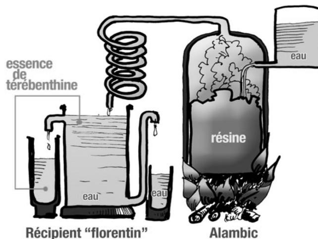
**Figure 4 - Schéma d'une hydrodistillation**
