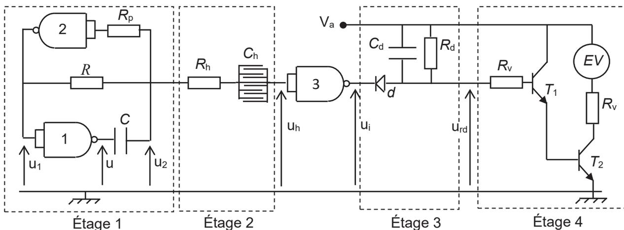
**Figure 9** - Schéma d'un système électronique d'arrosage automatique
