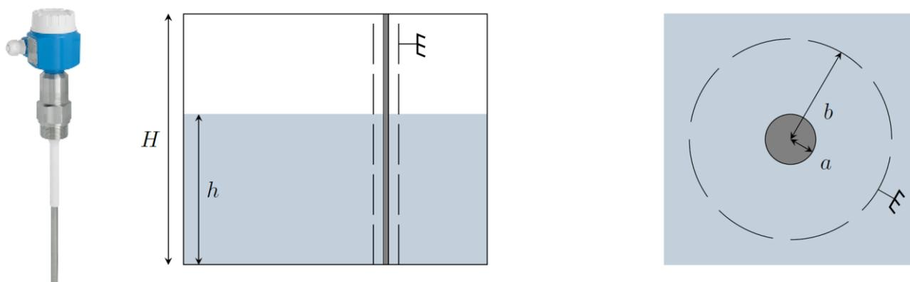
Figure : sonde à tube de masse
