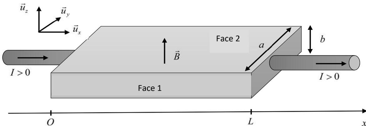
**Figure 2** - Plaque conductrice en présence de champ magnétique
