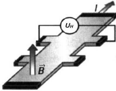
**Figure 1** - Mesure de la tension de Hall
