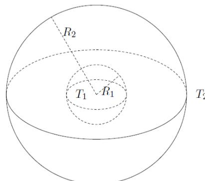
On note  $T_1$  la température intérieure et  $T_2$  la température extérieure à la sphère, le système étant supposé en régime stationnaire.
