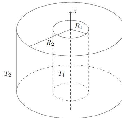
On note  $T_1$  la température intérieure et  $T_2$  la température extérieure à la canalisation, le système étant supposé en régime stationnaire.
