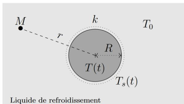
Figure 1 – Boule de supraconducteur en cours de refroidissement
