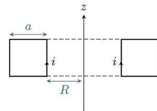
**Fig.1 – Transformateur torique à section carrée.** Les spires du primaire sont représentées en pointillés et celles du secondaire en traits pleins. Avec ce schéma, on aurait  $N_2 = 3N_1$ .
