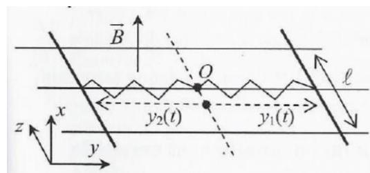
Les deux rails sont liés (séparément) au point O fixe par deux ressorts identiques de raideur  $k$  et de longueur à vide  $\ell_0$ . On repère leur position  $y_1(t)$  et  $y_2(t)$  par rapport au point de fixation commun O.
