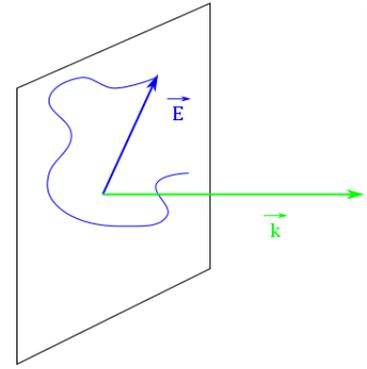
Etudier la polarisation de l'onde consiste à suivre en un point donné de l'espace l'évolution de la direction du vecteur champ électrique au cours du temps dans le plan transverse (plan d'onde).
