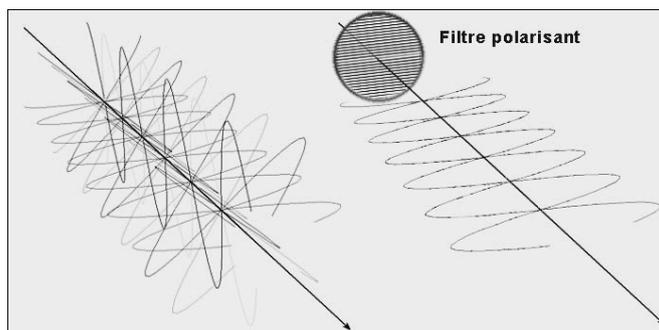
On représente le champ électrique. A gauche : lumière naturelle, non polarisée, à droite : lumière polarisée, direction unique du champ électrique.
