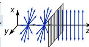
**La lumière sortant d'un polariseur est polarisée rectilignement, parallèlement à la direction de l'axe de transmission, quelle que soit la nature de la lumière incidente.**
