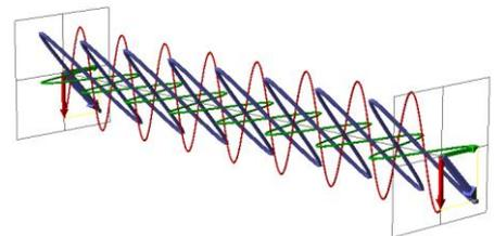
L'extrémité du champ électrique résultant décrit dans le plan d'observation (perpendiculaire à la direction de propagation) une direction parfaitement aléatoire au cours du temps, impossible à caractériser simplement : nous dirons alors que **la lumière naturelle est non polarisée**.
