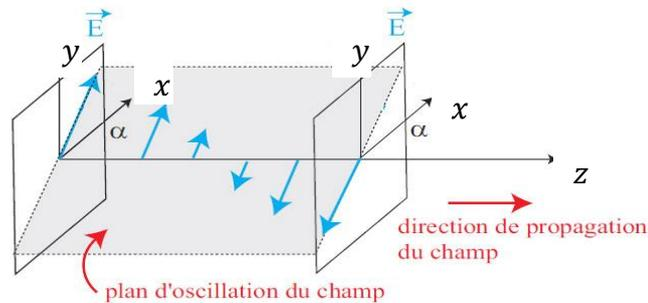
Plus généralement, avec  $\vec{E} = \underbrace{E_{0x} \cos(\omega t - kz)}_{E_x} \vec{u}_x + \underbrace{E_{0y} \cos(\omega t - kz + \Delta\varphi)}_{E_y} \vec{u}_y$ , dans le cas où  $\Delta\varphi = p\pi, p \in \mathbb{Z}$ ,
