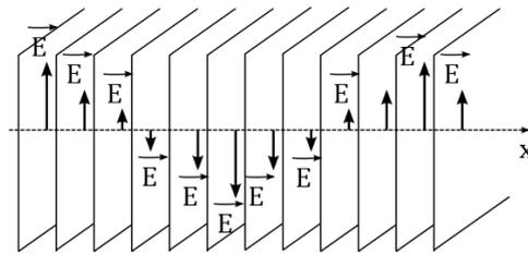
**Représentation d'une onde polarisée rectilignement** ; les flèches représentent le champ électrique  $\vec{E}$ . La direction de  $\vec{E}$  est constante, et la direction et l'amplitude de  $\vec{E}$  sont constants dans tout plan perpendiculaire à la direction de propagation
