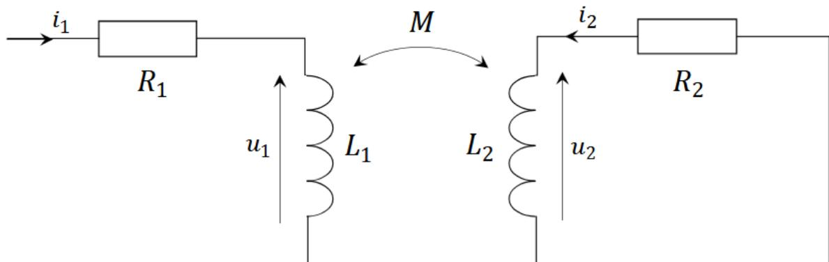
**Figure 8** - Circuit équivalent au système solénoïde central – plasma
