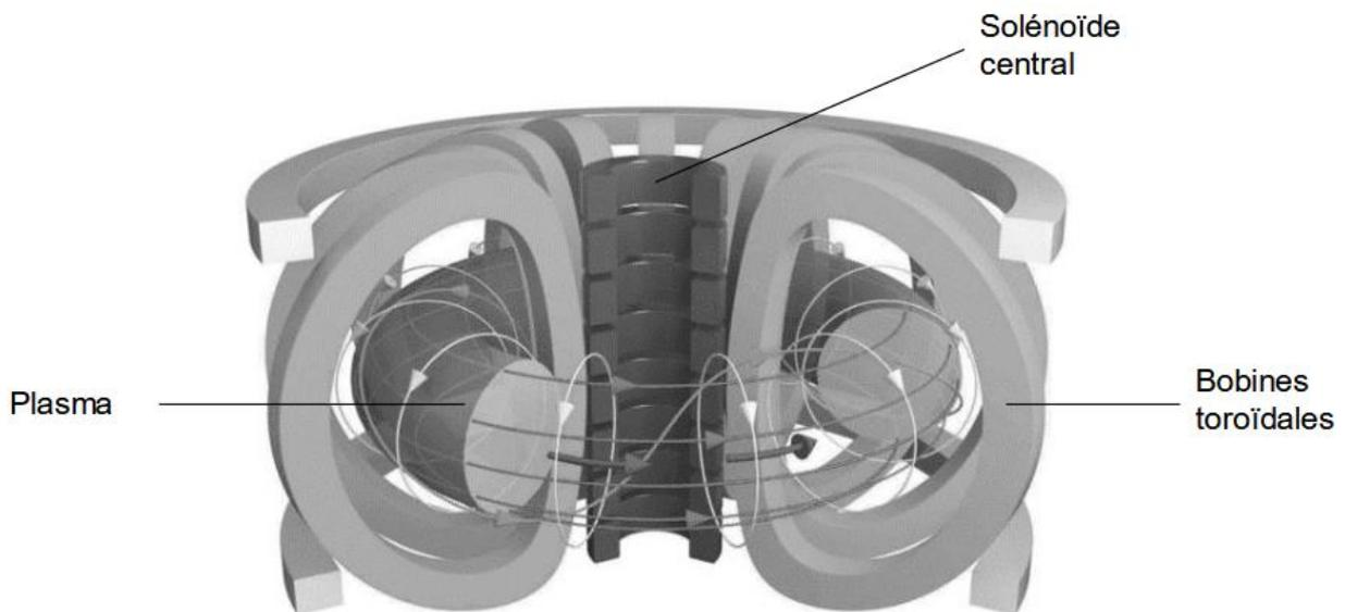
**Figure 2** - Schéma d'un tokamak
