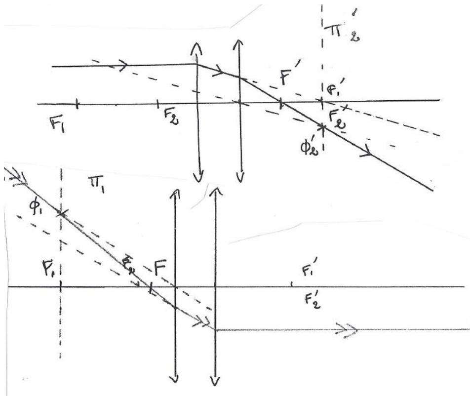
Exercice 5. marche d'un faisceau à l'infini à travers un doublet de lentilles
