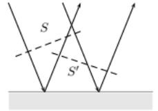
2- Les points A et B appartiennent à un même plan perpendiculaire mais ne sont pas en phase, le rayon passant par B ayant parcouru un chemin optique à travers la lame de milieu n tandis que le rayon passant par A a une différence de marche supplémentaire liée à la réflexion sur le milieu d'indice le plus réfringent soit ici en I; de même, S n'est pas une surface d'onde.
