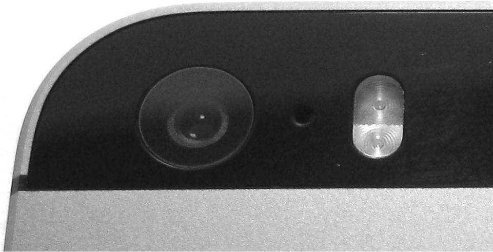
**Figure 2** Module photographique d'un smartphone (source : wikimediacommons)
