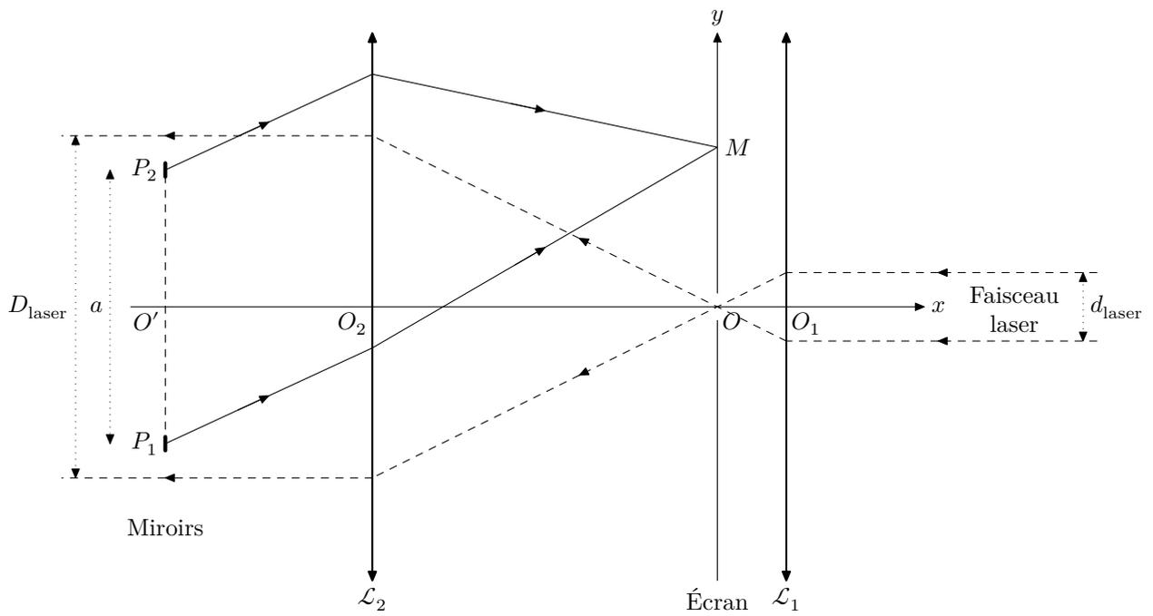
Figure 7 Deuxième montage : laser et miroirs
